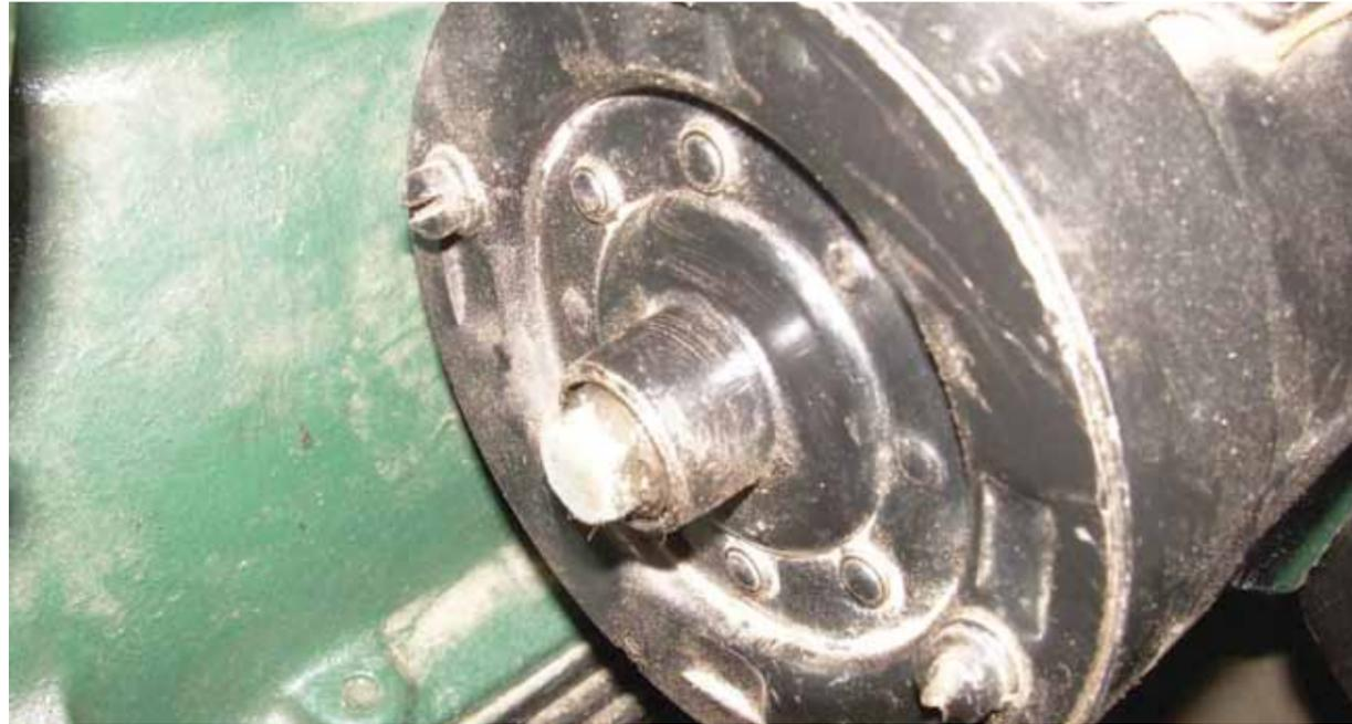
Para solucionar el problema del famoso “emburre”, o sea cuando se engrana el arranque y queda trabado, en cuyo caso hay que ponerlo en cambio y empujar entre varios para destrabar.
